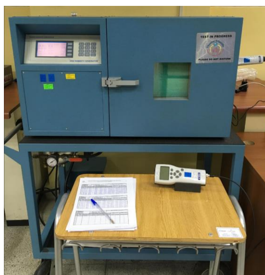
Figura 3. Montaje para la calibración del patrón viajero.
