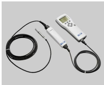
Figura 2. Patrón viajero usado en la comparación H-19 para participantes con cámara climática
